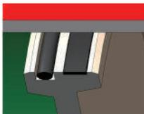
2. 活塞杆自润滑轴承：具有润滑、导向作用，降低了摩擦力，增加传导性能，有效将能量尽量传递给驱动轴，加强了弹簧使用效率。
